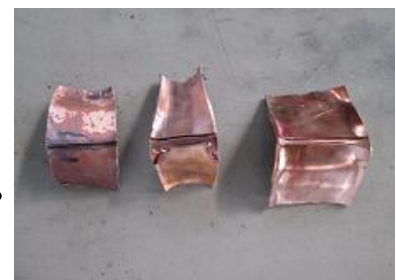
ろう付部を切断し内側評価
